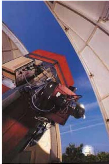
"Télescope de 1,20 m de l'Observatoire de Haute Provence ayant permis de mesurer le transit photométrique de HD189733. La coupole du télescope de 1,93 m, qui a permis les mesures de vitesses radiales, apparaît au deuxième plan."
