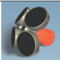
Courantomètre à 4 transducteurs piézoélectriques. Chaque transducteur est à la fois émetteur et récepteur des ondes acoustiques.
