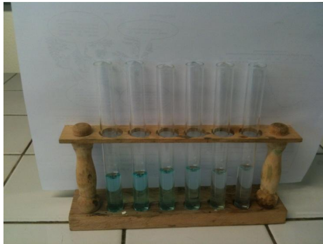
Échelle de teintes (solution de sulfate de cuivre) ( 1,0 \times 10^{-2} \text{ mol.L}^{-1} < c < 1,0 \times 10^{-1} \text{ mol.L}^{-1} )
