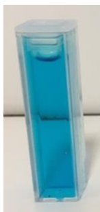
Cuve contenant du Bleu patenté
