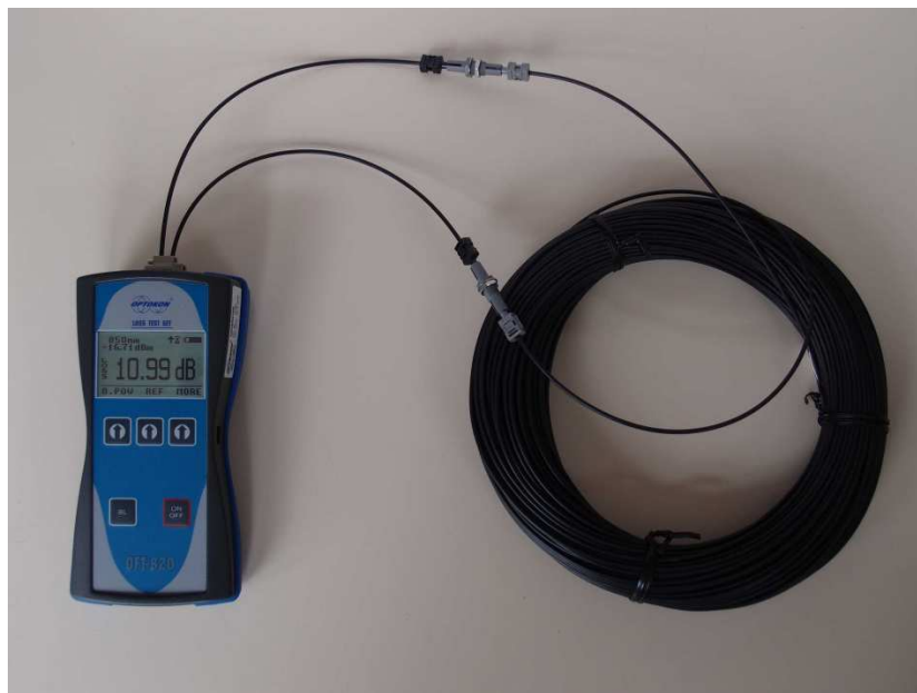
Figure 1. Mesure de l'atténuation dans une fibre POF (avec testeur OPTOKON-OFT820)
