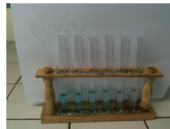
Echelle de teintes (solution de sulfate de cuivre) ( 1,0 \cdot 10^{-1} mol.L -1 > c > 1,0 \cdot 10^{-2} mol.L -1 )
